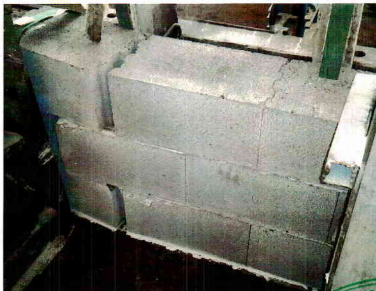
Рисунок 4.4.2.3 – общий вид разрушения образцов при изгибе по перевязанному сечению
